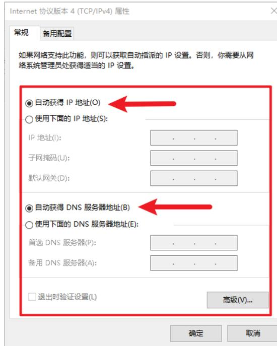
图 3-1 调试电脑配置自动获取 IP
