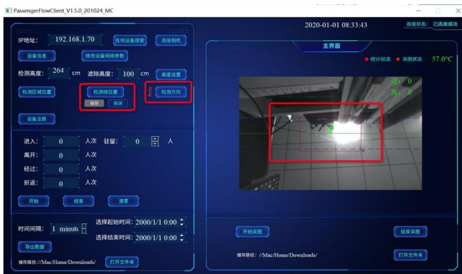
图 4-3 检测线及检测方向设置
