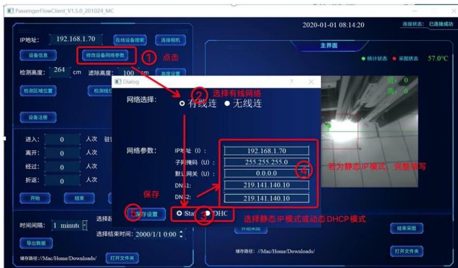
图 3-6 有线连接状态下网络参数配置
